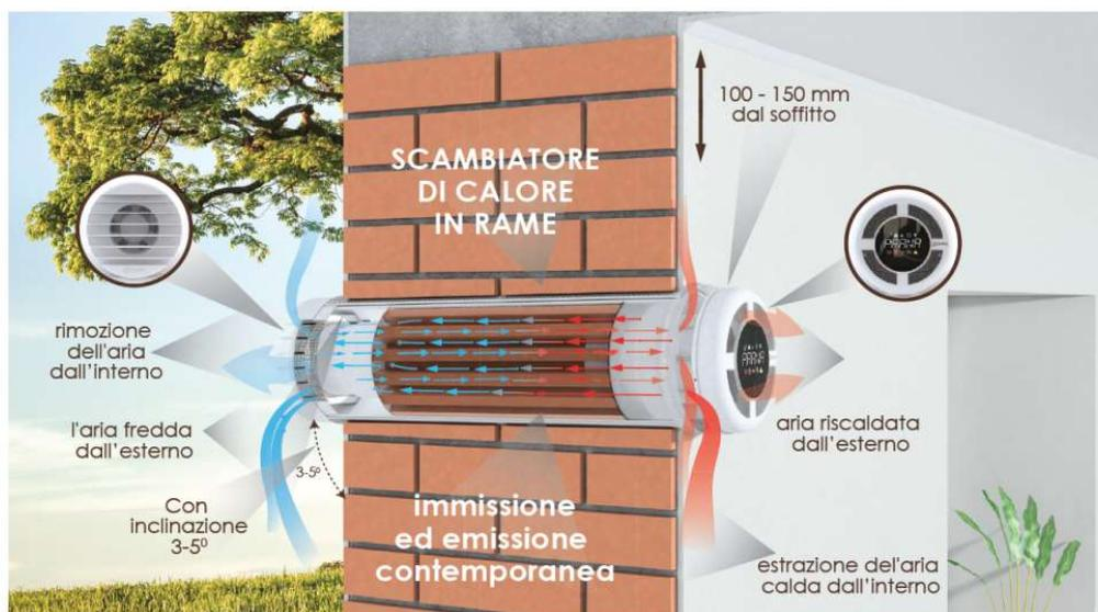
I flussi d'aria passano in mezzo al sistema degli scambiatori di calore in rame situati all'interno del modulo in funzione, ma sono divisi fra loro all'interno, e durante "l'entrata e uscita", e non si mescolano. Nel sistema di ventilazione previsto in progetto l'aria calda viziata che esce dall'interno, riscalda l'aria fredda che entra da fuori. In estate, invece, la raffredda.
